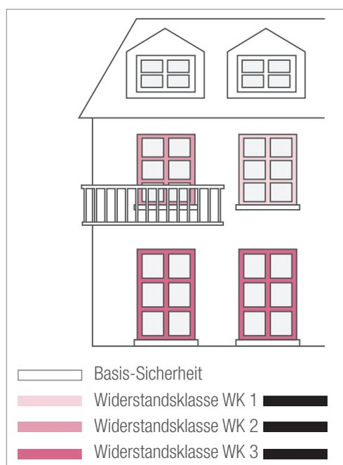
Spezielle Sicherheitskomponenten für individuelle Einbruchhemmung.
