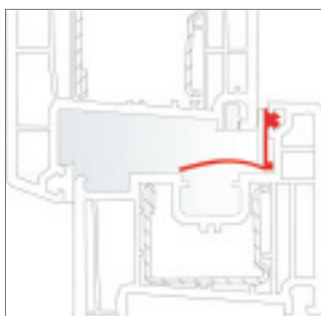
Lüfterstellung bei normalem Luftdruck
