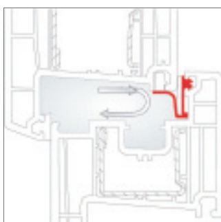
Bei steigendem Winddruck schließt der AirComfort automatisch nach dem Bernoulli-Prinzip
